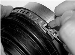
步骤 2 确定卡箍条带长度。
