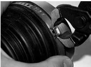
步骤 4 将卡箍置于工件，将挂钩挂上最紧的窗口位置，用欧梯克卡钳夹紧卡箍耳朵。
