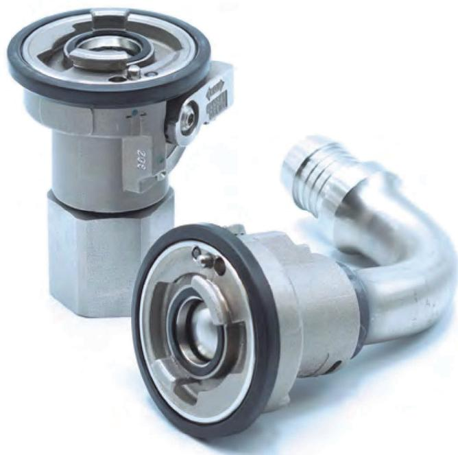
Danfoss Hansen 的 FD83 专为流体输送和电子冷却应用而设计，这些应用要求全流量，且流体相容性和安全性至关重要。FD83 的特点是左右两半接头完全相同，包括双互锁，可消除泄漏，确保最大的安全性。左右接头耦合前，阀芯不能开启；阀芯闭合前，左右接头无法断开。
